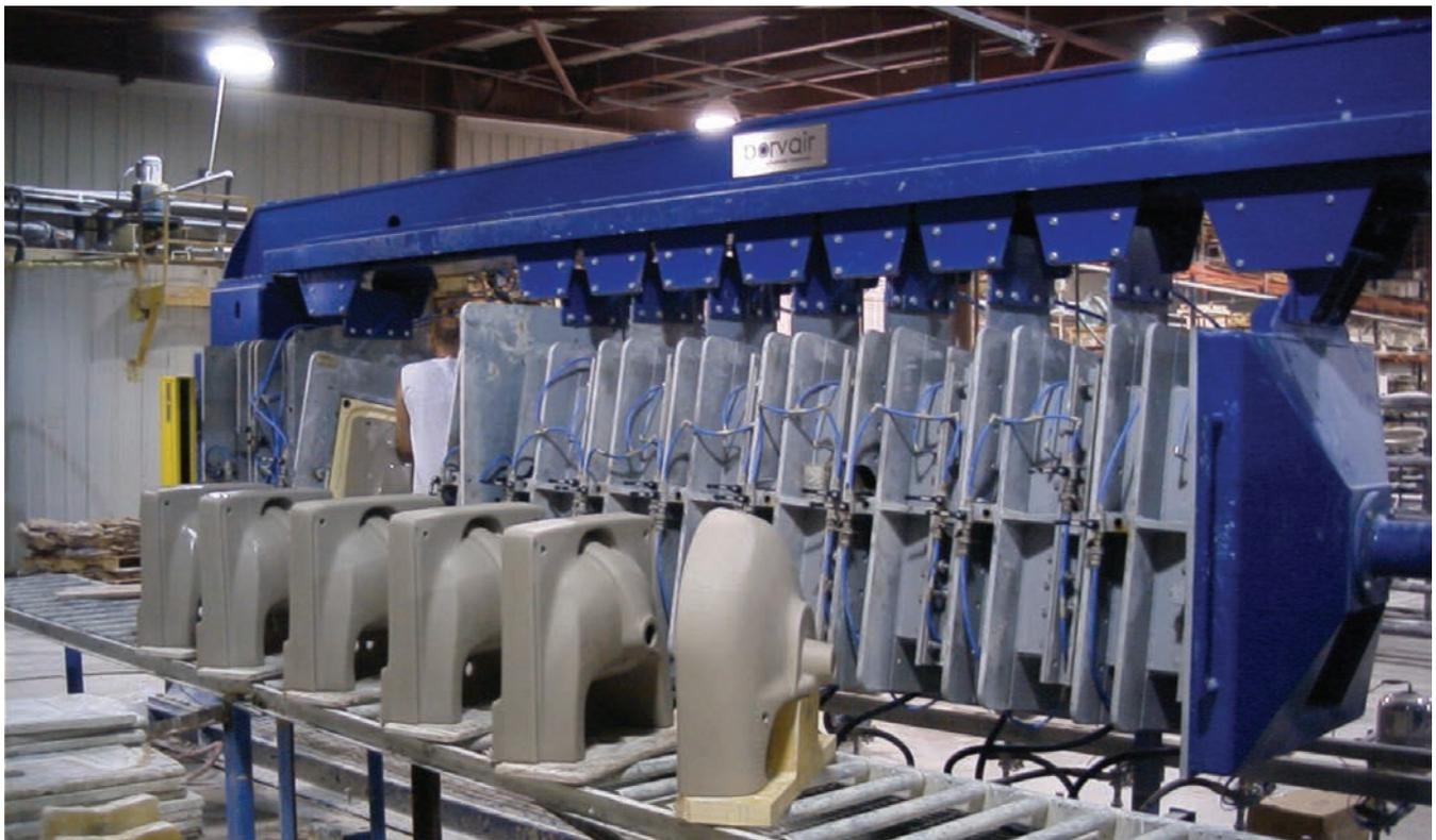
vaciado de moldes de dos piezas - Desmoldeo manual
