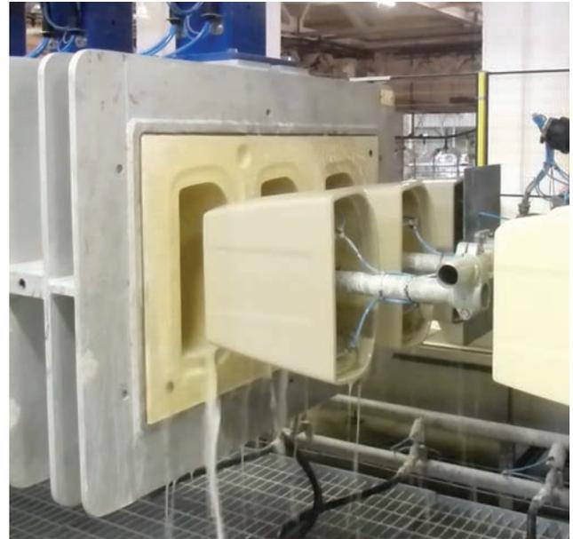
vaciado de moldes de dos piezas - máquina de tanques y tapas automática
