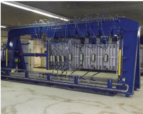
Instalación de máquinas múltiples para tanques, tapas, lavabos y pedestales de lavabo
