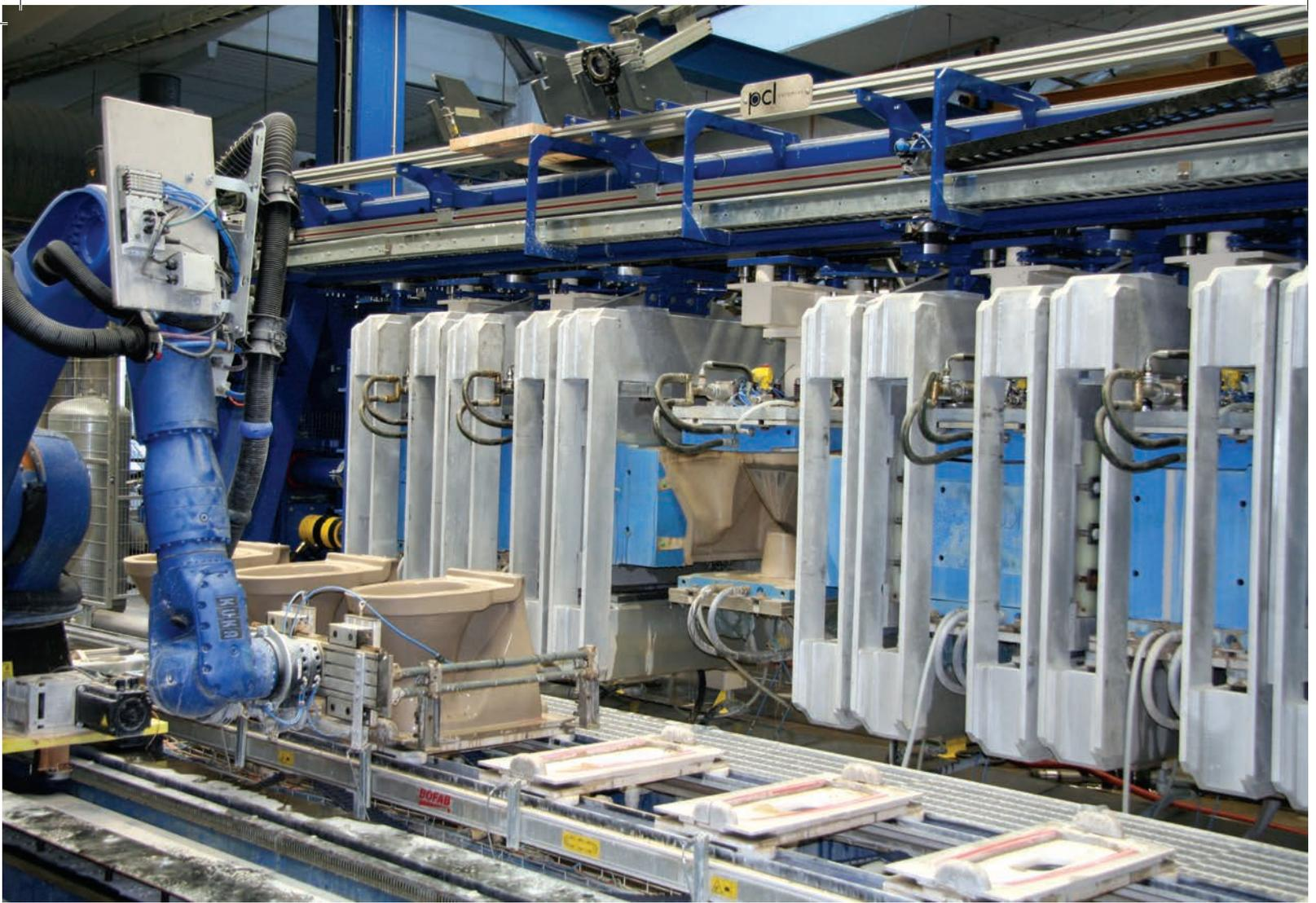
Máquina de ocho tazas fabricada a medida con cinta transportadora
