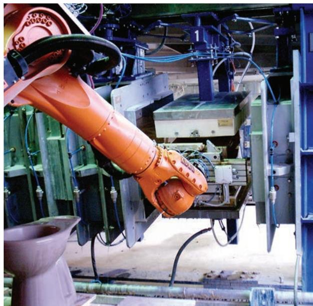
Машина для отливки унитазов PCB5/70
