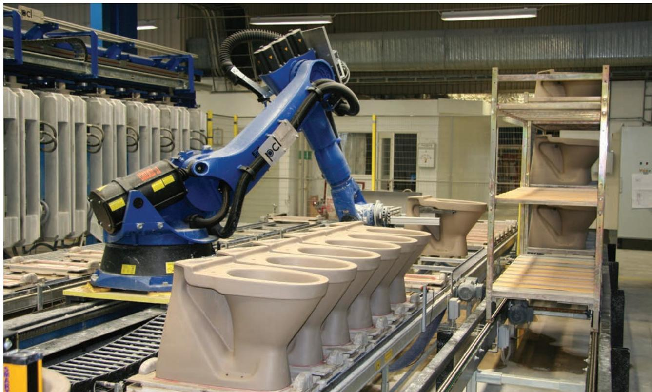
Полностью автоматическая отливка пятикомпонентных унитазов
