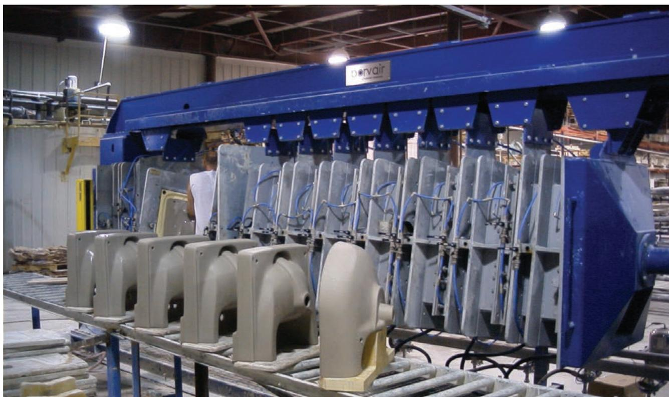
Отливка в двухкомпонентные пресс-формы — извлечение отлитой заготовки вручную
