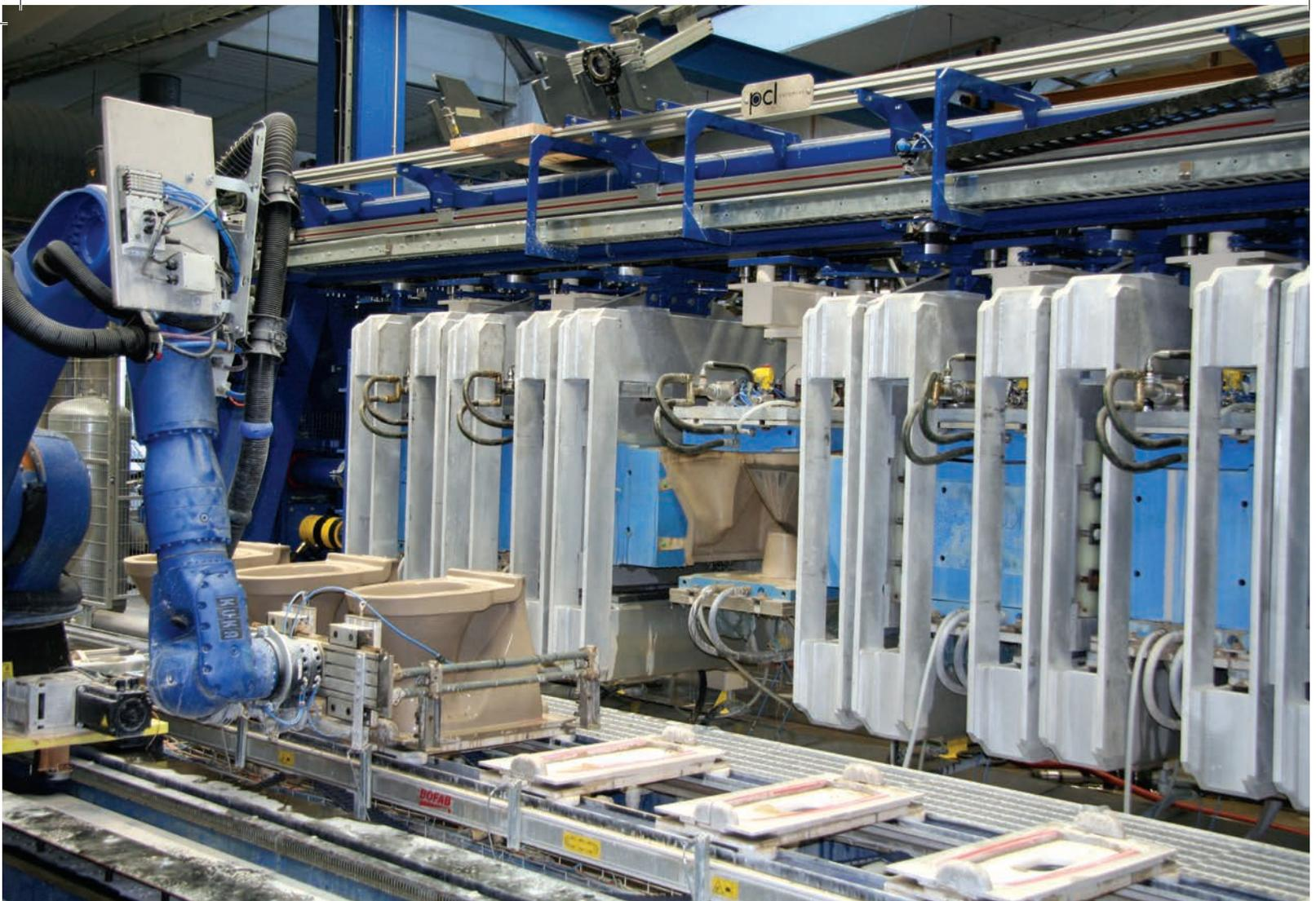
Заказное решение с конвейером для одновременного изготовления восьми унитазов
