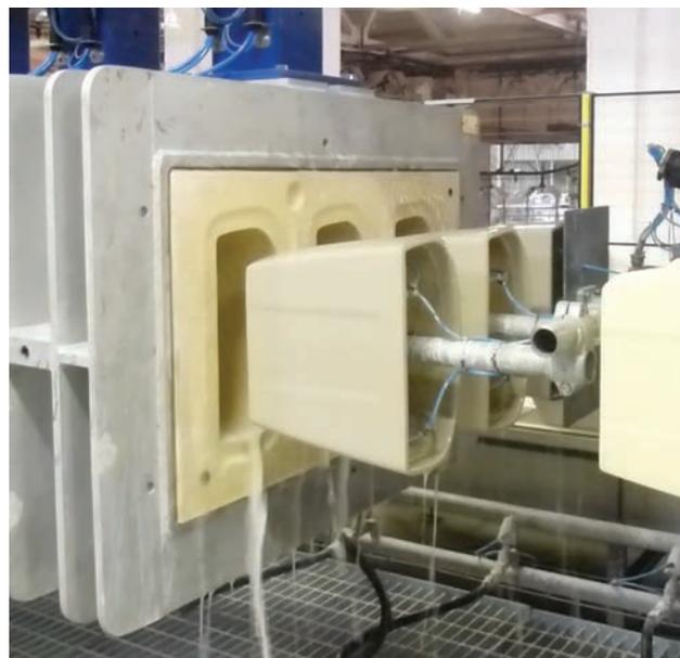
Отливка в двухкомпонентные пресс-формы — машина для автоматической отливки сливного бачка и его крышки
